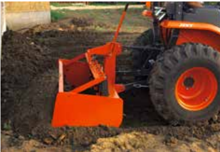
Boîte de nivelage
