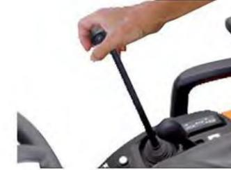
**Étape 3 :** Utilisez le levier du chargeur pour séparer le châssis du chargeur de la flèche. Arrêtez le moteur et actionnez le joystick du chargeur afin de libérer la pression hydraulique.
