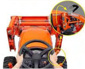
**Étape 4 :** Tirez sur un levier pour débrancher rapidement et facilement toutes les conduites hydrauliques en même temps et rangez l'attache sur la flèche du chargeur.
