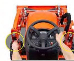
**Étape 2 :** Débloquez les leviers des verrous de chargeur afin de détacher les crochets du chargeur frontal.
