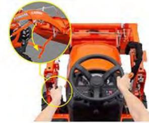
**Étape 1 :** Levez la flèche du chargeur et basculez complètement le godet vers l'avant. Tirez sur le levier de libération du support pour abaisser le support du chargeur frontal. Repositionnez le godet de façon à ce qu'il soit légèrement en position de déversement (position de déversement de 20 degrés) et abaissez la flèche jusqu'à ce que l'essieu avant décolle du sol.
