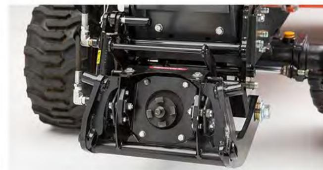
L'attelage avant à 4 points Kubota permet de fixer et de retirer facilement les outils frontaux tels qu'une lame, un balai ou une souffeuse à neige
